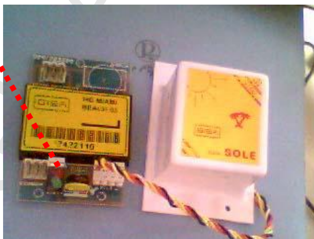
COLLEGAMENTO DELLA PILA E DEL MORSETTO DI PROVA ALLA SCHEDA
